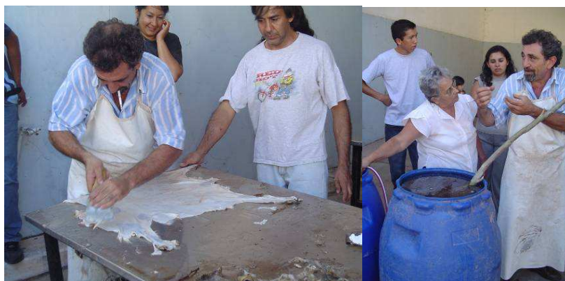
Figura 3 – Cueros en proceso de reverdecimiento: realizando el descarne y remojo
