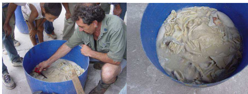
Figura 7 – Control del proceso de piclado: Medición de pH
