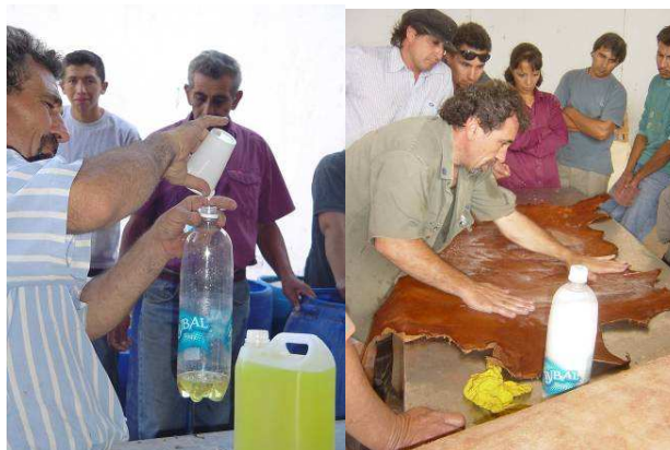
Figura 11 – Preparación de la emulsión y aplicación de la misma para nutrir el cuero
