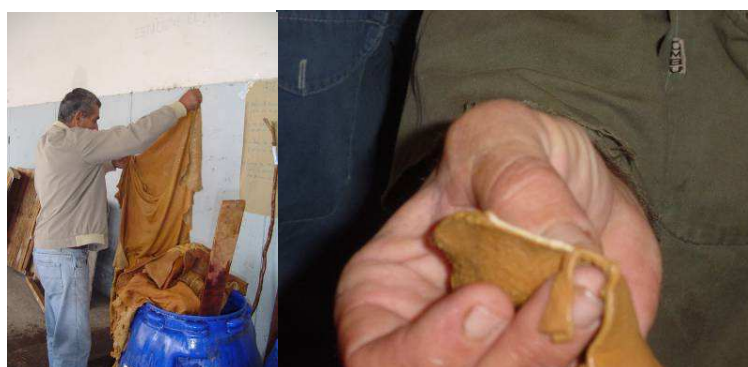
Figura 10 – Control del proceso de curtido: absorción de tanino
